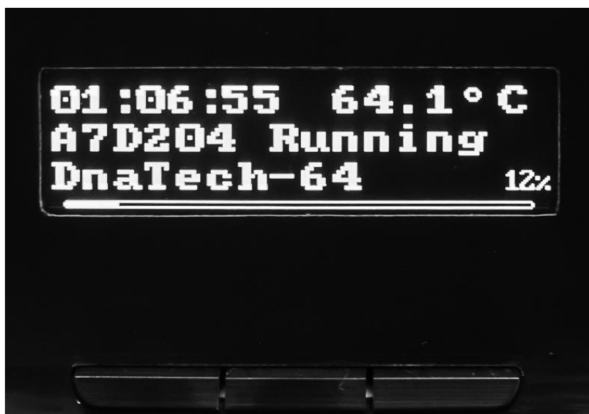
Рис.3. Жидкокристаллический индикатор и кнопки управления
